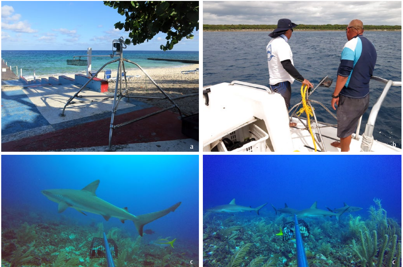
Figura 6.9 Dispositivos remotos (BRUVS) bentónicos: a) dispositivo, b) colocación de un dispositivo desde la embarcación y c) imágenes obtenidas del dispositivo colocado en el fondo de un arrecife. FOTOS: DORKA COBIÁN ROJAS/PNG
